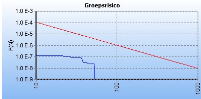
5.3 Figuur 5.3 FN curve voor N-560-03 van N.V. Nederlandse Gasunie voor de kilometer tussen stationing 10570.00 en stationing 11570.00
