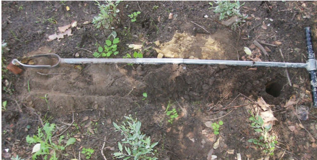
Afbeelding 4. Beeld van boring 8. Het onderscheid in de donkere en grijzere kleur in het esdek worden veroorzaakt door een verschil in het vochtgehalte
