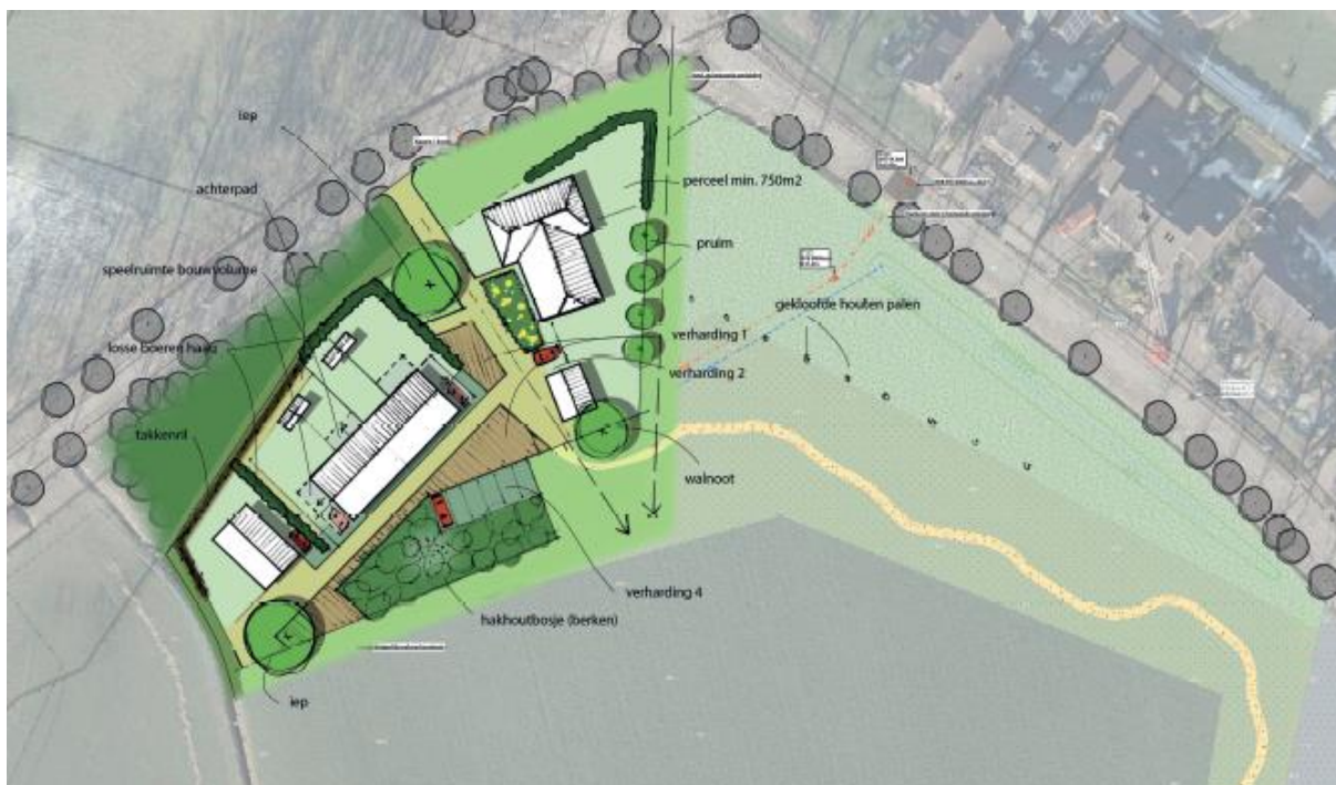
Figuur 8. Schetsontwerp voor het wooncluster langs de Droppersweg. Op deze schets zijn ook het kruidenrijke grasland (lichtgroen), de takkenrillen (donkerbruin) en hagen (donkergroen) aangegeven. Het grondwallepje zal in het kruidenrijke grasland worden aangebracht.
