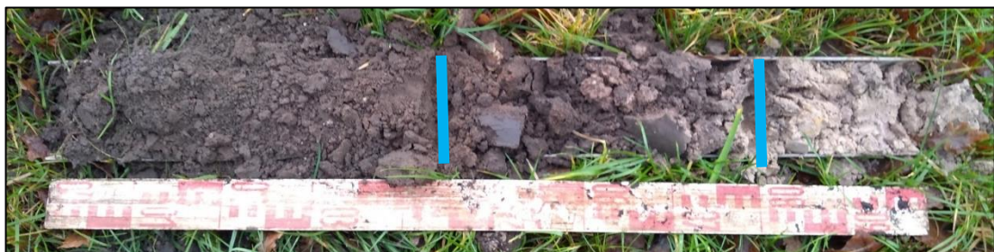
Afbeelding 14: Boring 2 (deelgebied noord) met achtereenvolgens de bouwvoor, de eerdlaag en de C-horizont
