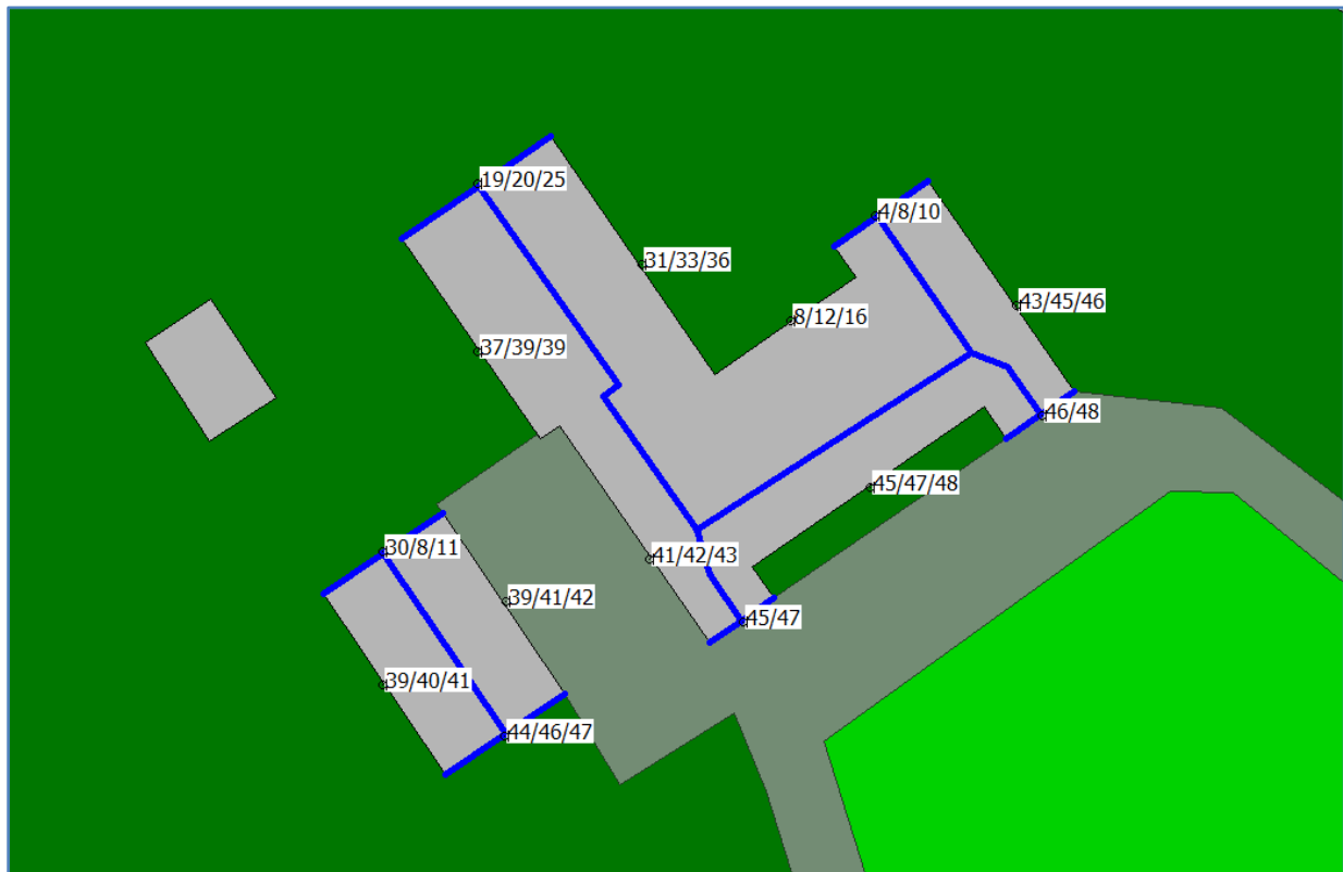
Afbeelding 5. Geluidbelastingen L_{den} (incl. aftrek art. 110g Wgh) Vredenseweg (N820) Berekende geluidbelastingen op een hoogte van 1,5 / 4,5 / 7,5 meter
