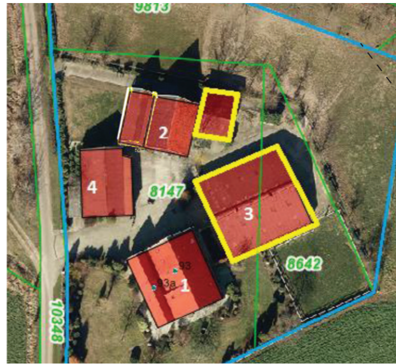
luchtfoto bestaande bebouwing. Geel omlijnd de twee te slopen gebouwen. 1. Hoofdgebouw - om te vormen naar twee wooneenheden 2. Schoppe - om te vormen naar woning 3. Ligboxenstal - te slopen 4. Schuur - bijgebouw tbv woningen
