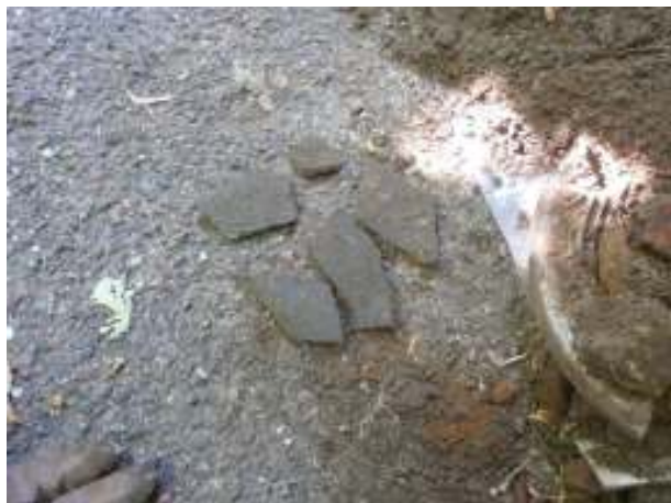
Aangetroffen golfplaat materiaal in proefgat 4
