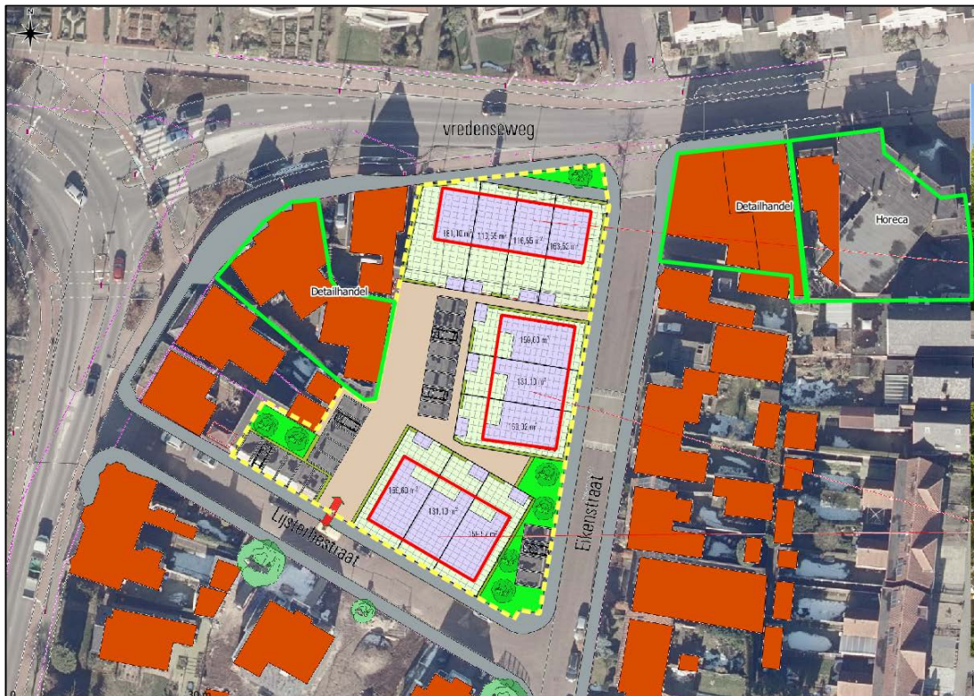
Figuur 1: plangebied (binnen gele kader, gevels woningen binnen rode kaders) en milieuhinder veroorzakende functies (binnen groene kaders)
