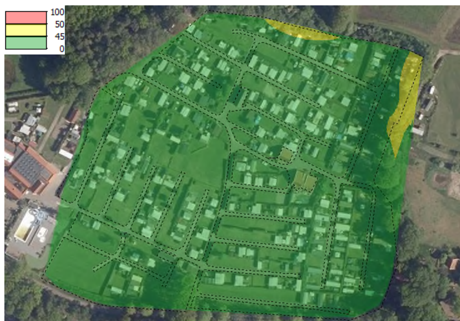
Figuur 4.1: Het langtijdgemiddeld beoordelingsniveau ter plaatse van het recreatiepark. Deze resultaten hebben betrekking op de goede ruimtelijke ordening. (Bron achtergrondfoto Pdok)
