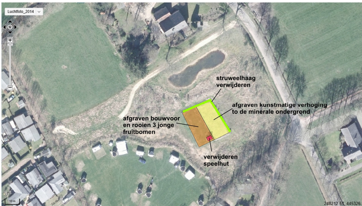
Figuur 5. Te verwijderen onderdelen en grondwerk locatie 1.
