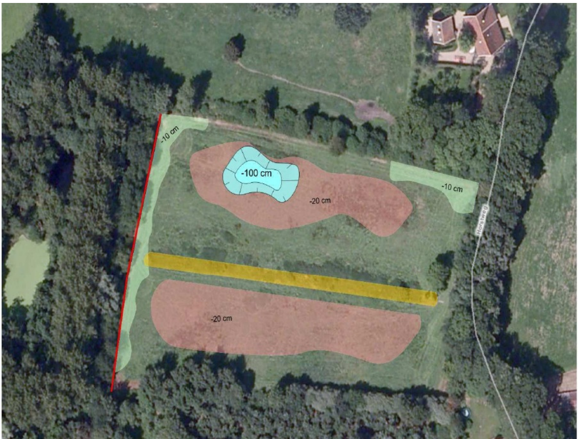
Afbeelding 1.2: Geplande vergravingsdieptes binnen het plangebied. De te graven poel is in lichtblauw aangegeven (Bron: (tekening aangeleverd door de opdrachtgever).
